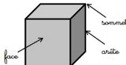
Un solide est une forme géométrique en trois dimensions (largeur / hauteur / profondeur). Si chacune de ses faces est un polygone, on dit que c'est un polyèdre. Les solides sont composés de faces, de sommets et d'arêtes.
